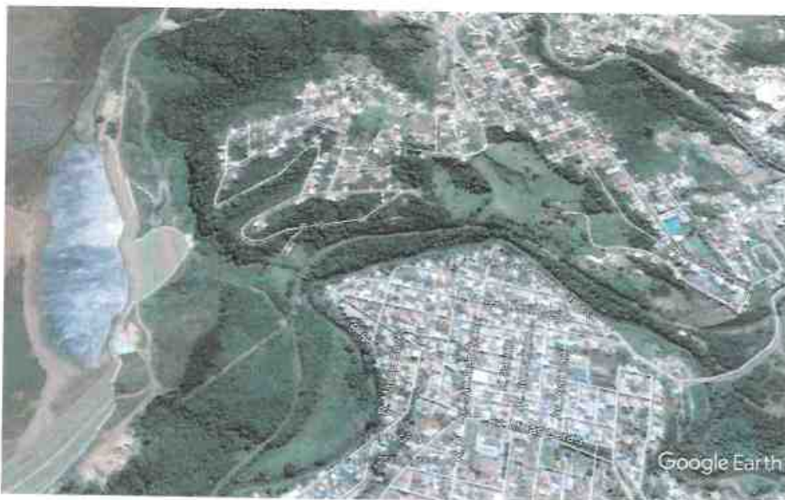
Figura 8: Imagem mostrando a proximidade do Dique da Sela de alguns bairros da cidade de Congonhas e o contorno da encosta funcionando como barramento do reservatório
