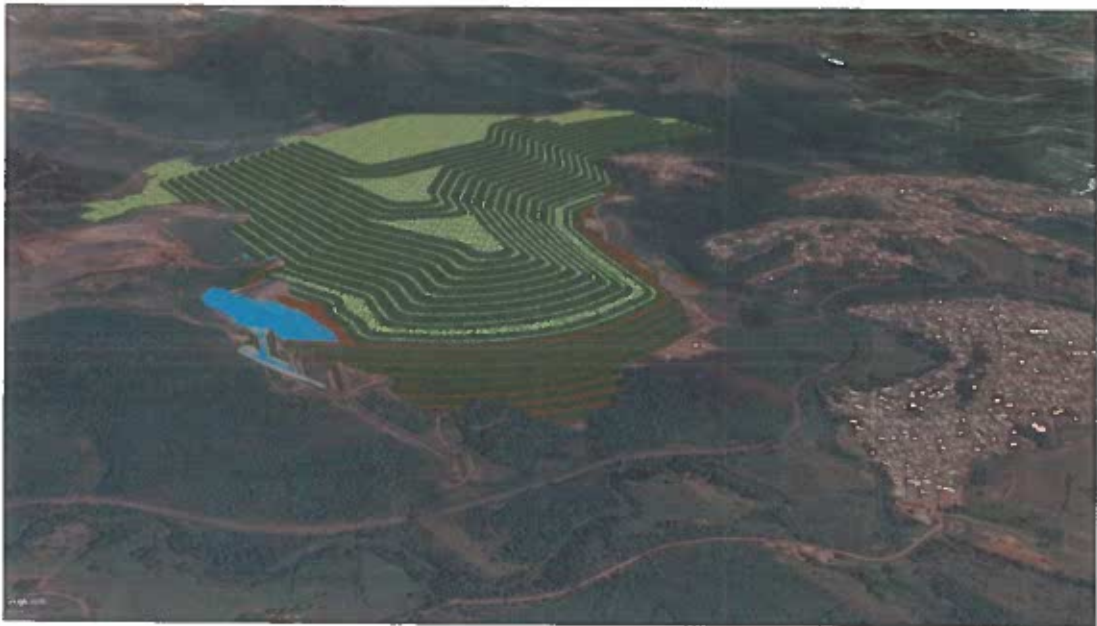
Figura 7: Simulação da etapa final de fechamento das barragens Casa de Pedra, B4 e B5
